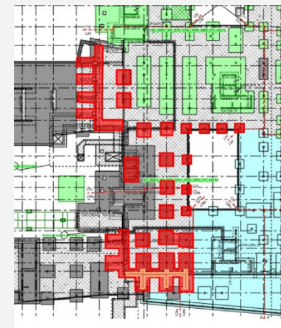
Støbte fundamenter i basebygning (øverst er mod Tuborgvej)
