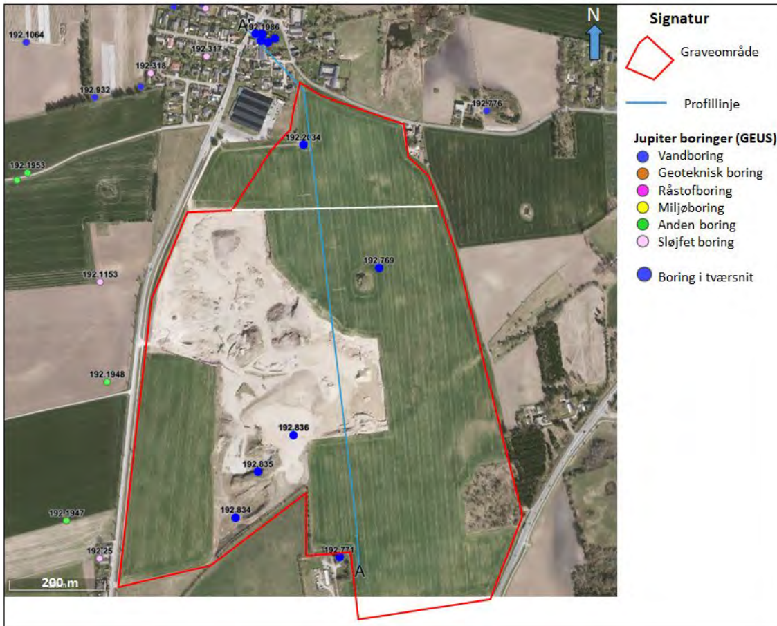
Figur 3: Graveområde med profillinje og borer. De store blå markeringer er de borer, der indgår i den geologiske tolkning af tværsnittet (figur 2).
