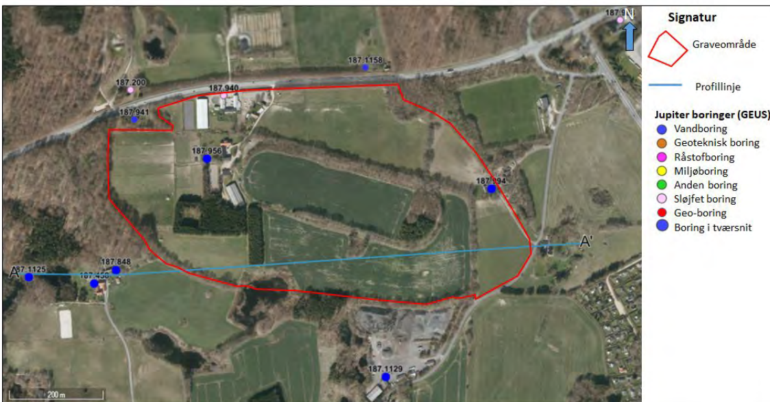
Figur 3: Graveområde med profillinje og borer. De store blå markeringer er de borer, der indgår i den geologiske tolkning af tværsnittet (figur 2).
