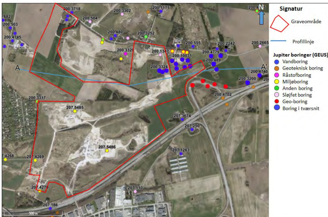
Figur 3: Graveområde med profilinje og borer. De store blå markeringer er de borer, der indgår i den geologiske tolkning af tværsnittet (figur 2).
