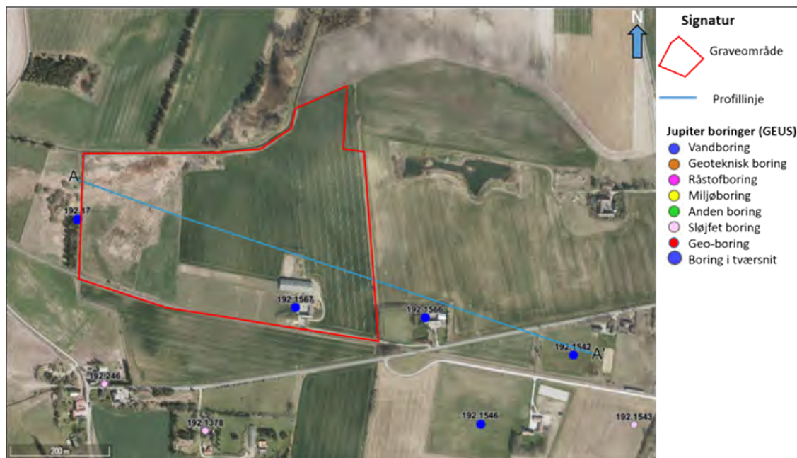
Figur 5. Graveområde 25 med profillinje og boringer. De store blå markeringer er de boringer, der indgår i den geologiske tolkning af tværsnittet (figur 4).
