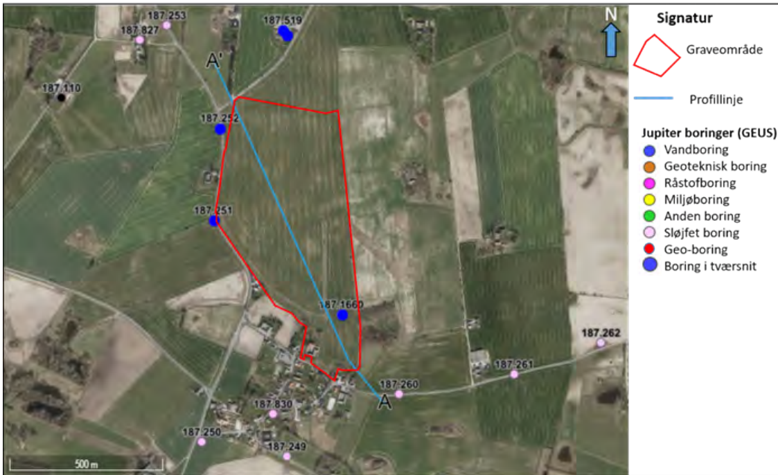
Figur 3. Graveområde 6 Mønge med profillinje og boringer. De store blå markeringer er de boringer, der indgår i den geologiske tolkning af tværsnittet (figur 2).
