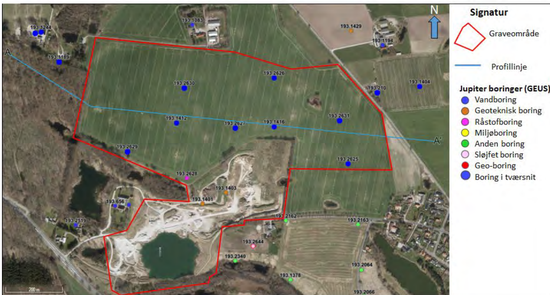
Figur 3: Graveområde med profillinje og borer. De store blå markeringer er de borer, der indgår i den geologiske tolkning af tværsnittet (figur 2)
