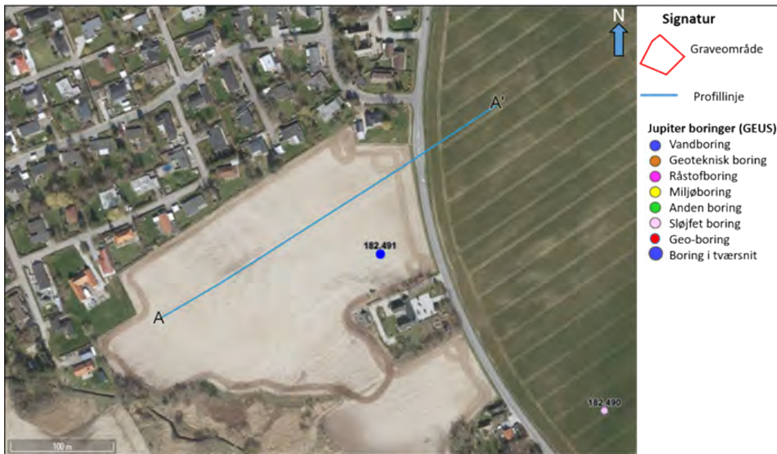
Figur 3. Graveområde 1 Blistrup med profillinje og borer. Borningsnumre der indgår i den geologiske tolkning fremgår af tværsnittet (figur 4).
