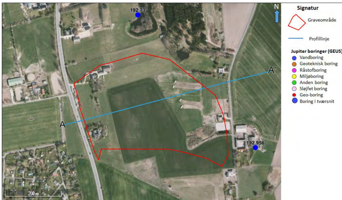
Figur 3: Graveområde med profillinje og borer. De store blå markeringer er de borer, der indgår i den geologiske tolkning af tværsnittet (figur 2).
