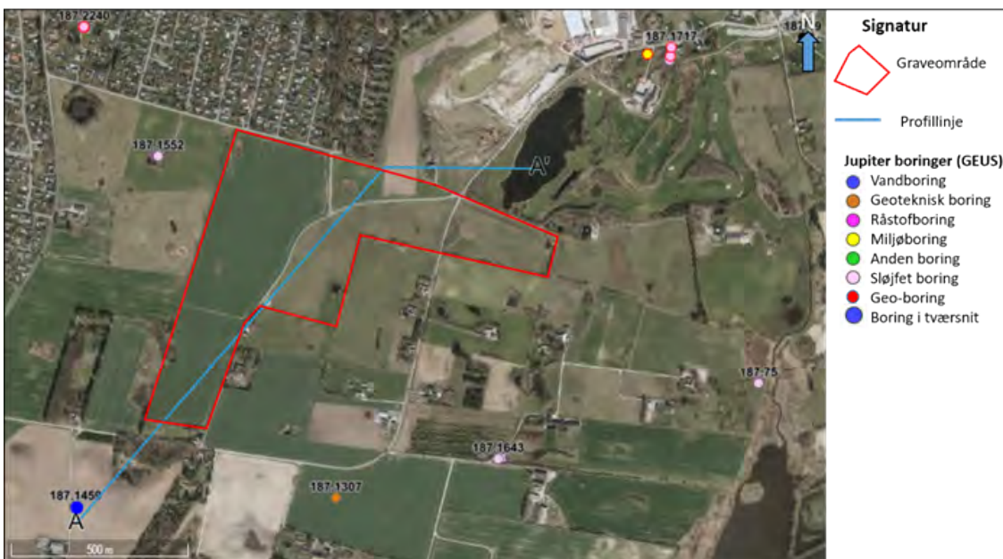
Figur 3. Graveområde 12 Anisse Syd med profilinje og borer. De store blå markeringer er de borer, der indgår i den geologiske tolkning af tværsnittet
