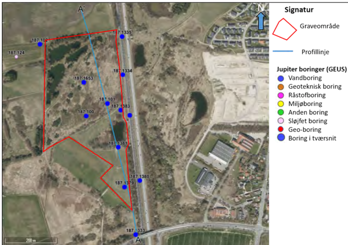
Figur 3. Området med profillinje og boringer. De store blå markeringer er de boringer, der indgår i den geologiske tolkning af tværsnittet (figur 2).
