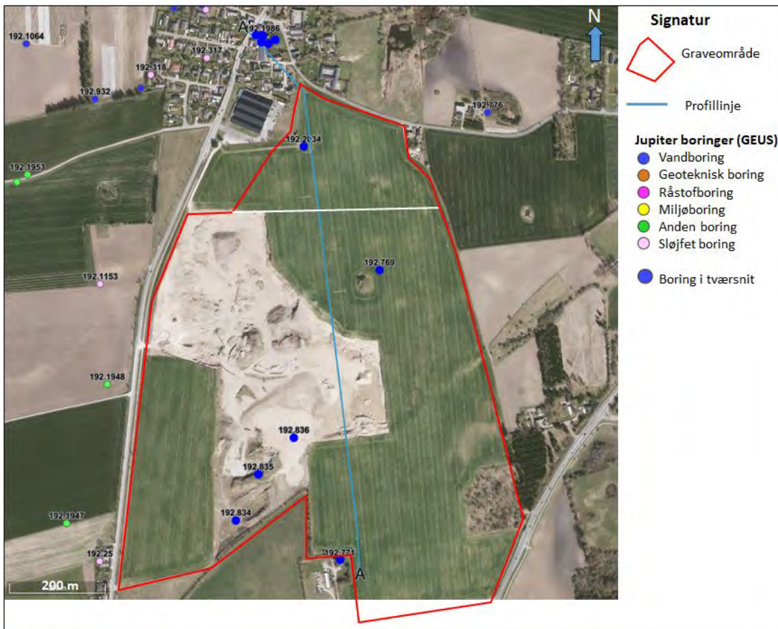
Figur 3: Graveområde med profillinje og boringer. De store blå markeringer er de boringer, der indgår i den geologiske tolkning af tværsnittet (figur 2).
