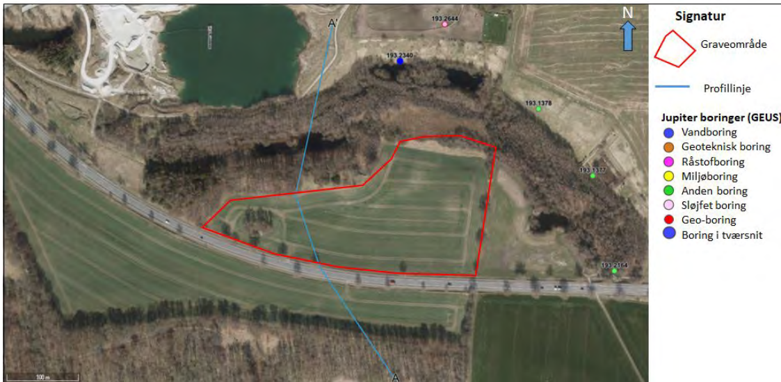
Figur 3: Graveområde med profilinje og borer. De store blå markeringer er de borer, der indgår i den geologiske tolkning af tværsnittet (figur 2).
