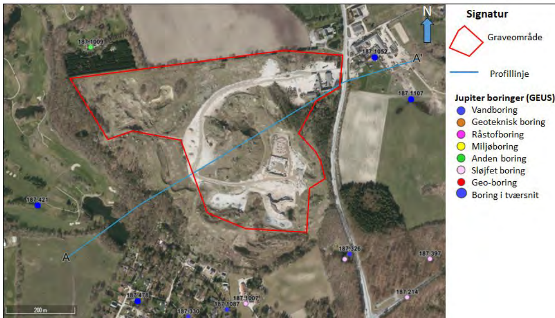
Figur 3: Graveområde med profilinje og borer. De store blå markeringer er de borer, der indgår i den geologiske tolkning af tværsnittet (figur 2).
