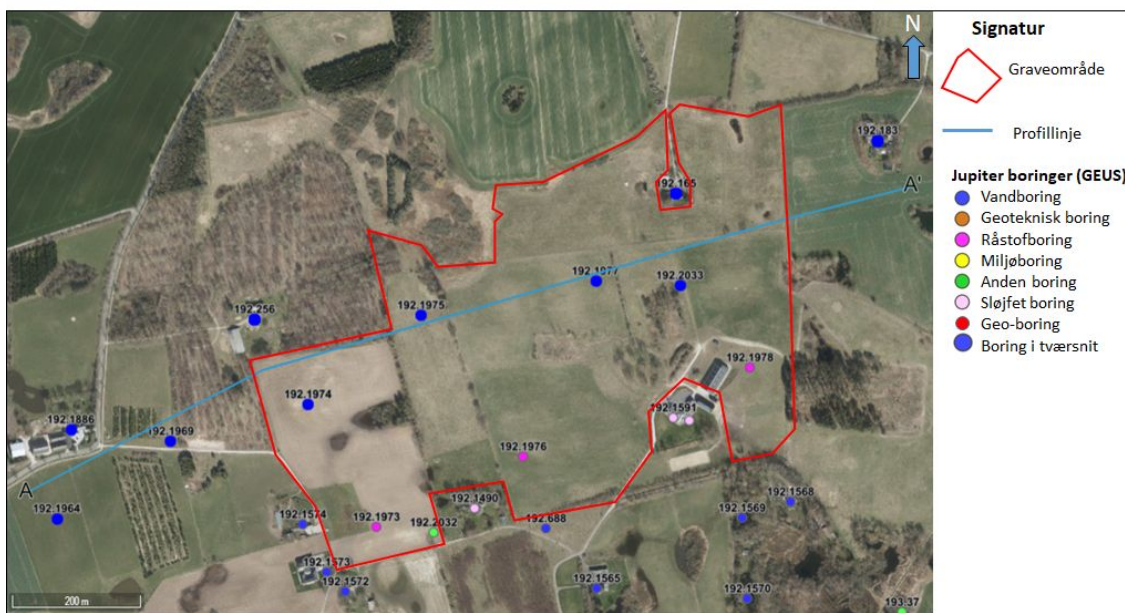
Figur 3: Oprindelig afgrænsning af graveområde med profillinje og borer. De store blå markeringer er de borer, der indgår i den geologiske tolkning af tværsnittet (figur 2).
