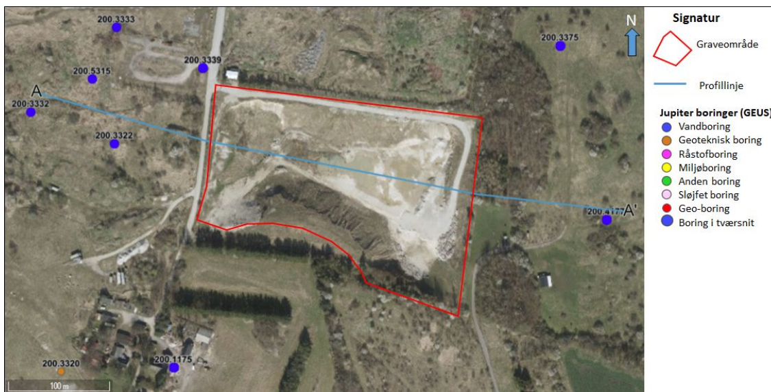
Figur 3: Graveområde med profillinje og borer. De store blå markeringer er de borer, der indgår i den geologiske tolkning af tværsnittet (figur 2).
