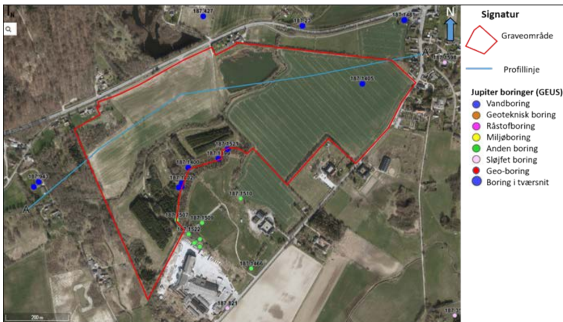
Figur 3. Graveområde 9 Mårum med profilinje og borer. De store blå markeringer er de borer, der indgår i den geologiske tolkning af tværsnittet (figur 2).
