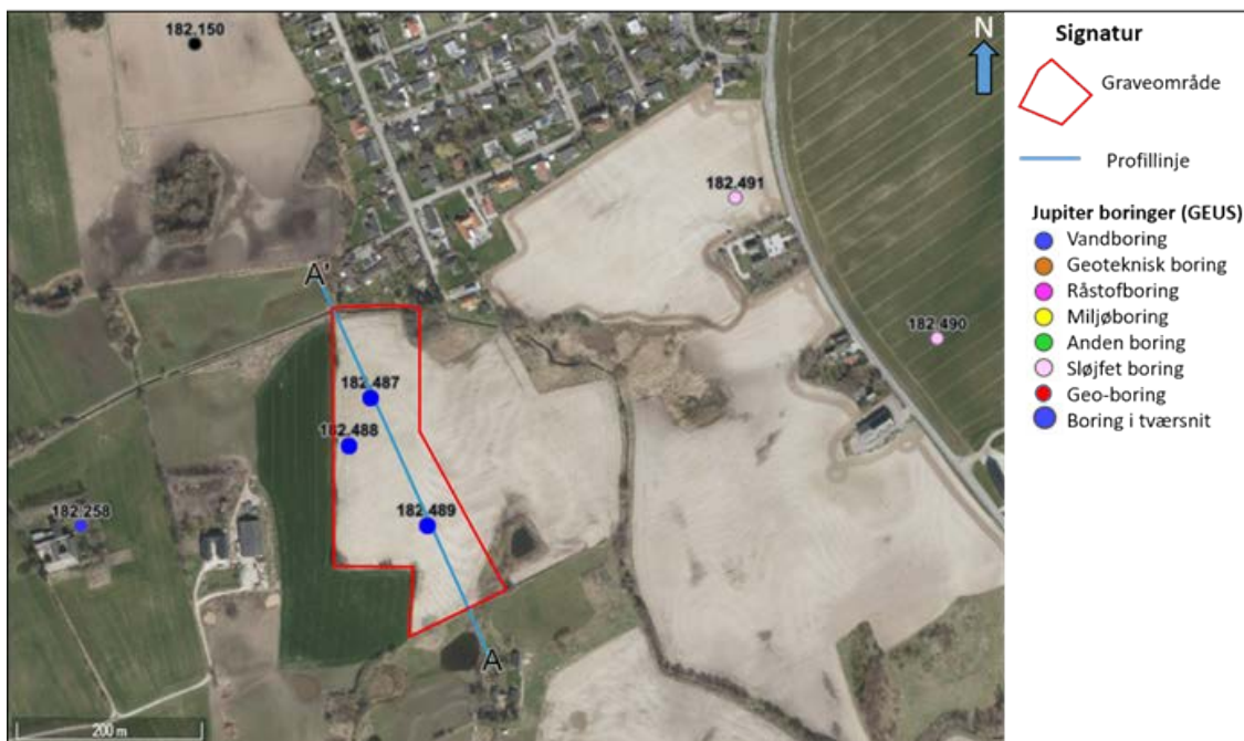
Figur 5. Graveområde 3 Blistrup med profillinje og borer. De store blå markeringer er de borer, der indgår i den geologiske tolkning af tværsnittet (figur 4).
