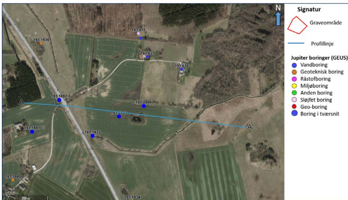
Figur 3. Graveområde 26 Kollerød med profillinje og borer. De store blå markeringer er de borer, der indgår i den geologiske tolkning af tværsnittet (figur 2).
