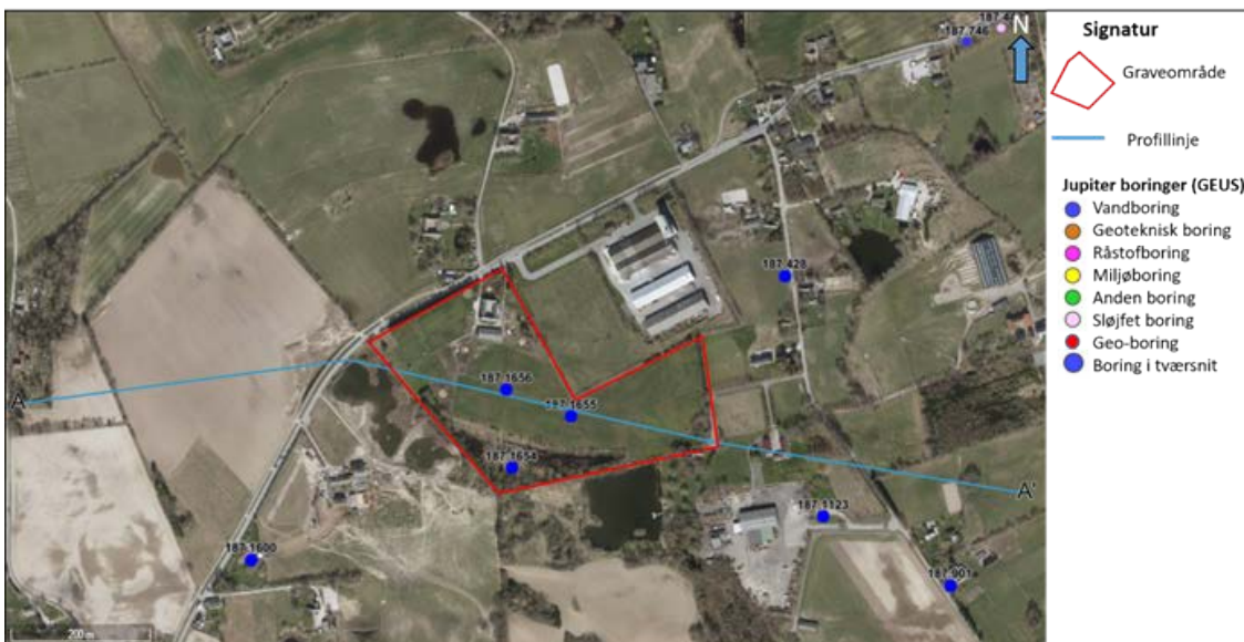
Figur 3. Graveområde 7 Dønnevælde med profillinje og borer. De store blå markeringer er de borer, der indgår i den geologiske tolkning af tværsnittet (figur 2).
