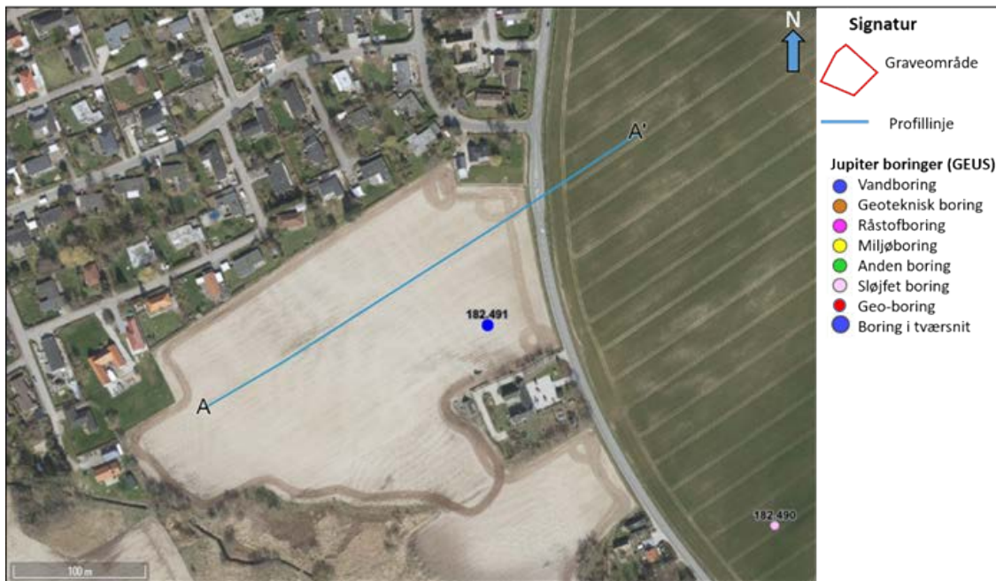
Figur 3. Graveområde 1 Blistrup med profilinje og borer. Borningsnumre der indgår i den geologiske tolkning fremgår af tværsnittet (figur 4).
