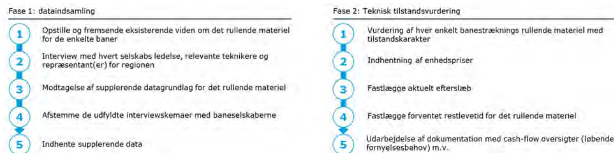
Figur 17: Metode til vurdering af det rullende materiels fornyelsesbehov, hvor de to faser er udført parallelt.
