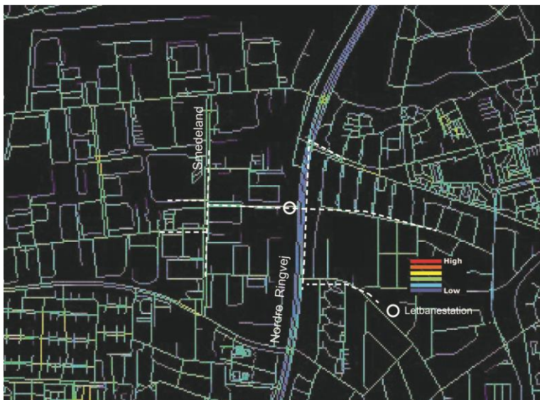
Figur 10. Udsnit af strategisk netværksanalyse Integration. Udsnittet viser, hvilke veje, der skal forbindes i området, for at skabe let adgang til stationen og derved også skabe større oplevet trykthed ved potentielt at generere trafikanter omkring stationen.
