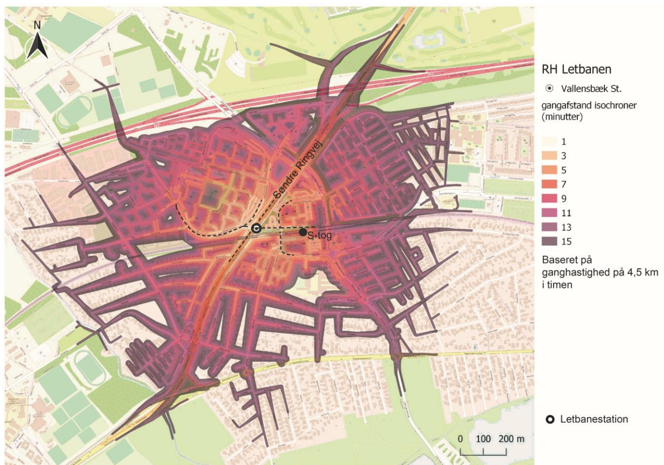
Figur 12. Kortet over mikromobilitet viser, at boligområdet til vest og bycentret til øst har kortest gåafstand til letbanestationen.
