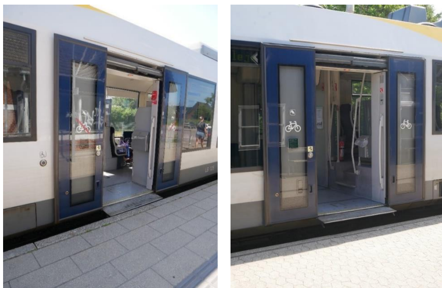
Figur 36: Indstigning ved hhv. 55 (Skævinge) og 35 cm (Græsted Syd) perroner. Bemærk "gap filler", der dækker hullet mellem tog og perron.
