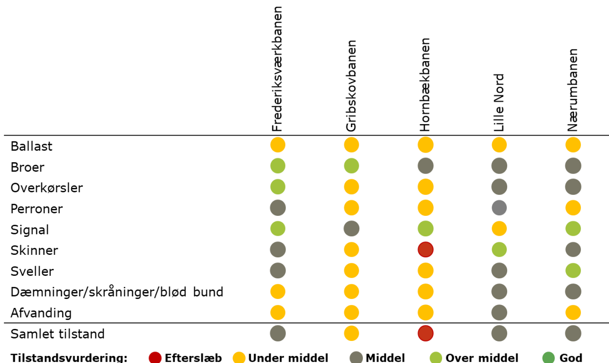
Figur 20: Tilstandsvurdering af lokalbanernes infrastrukturs delelementer i 2023. Kilde: Infrastrukturanalyse 2026-2035.
