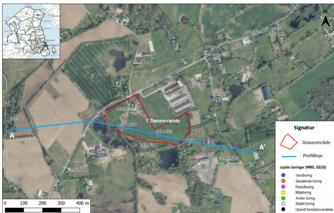
Figur 3. Området 7 Dønnevælde med profilinje og borer.
