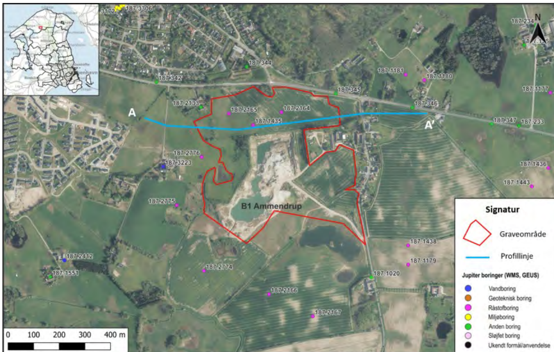
Figur 3. Graveområde B1 Ammendrup og Ammendrup Udvidelse med profilinje og boringer.
