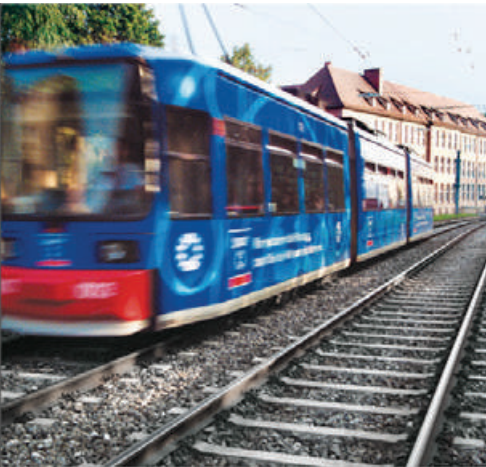
Eksempel på ballasteret spor
