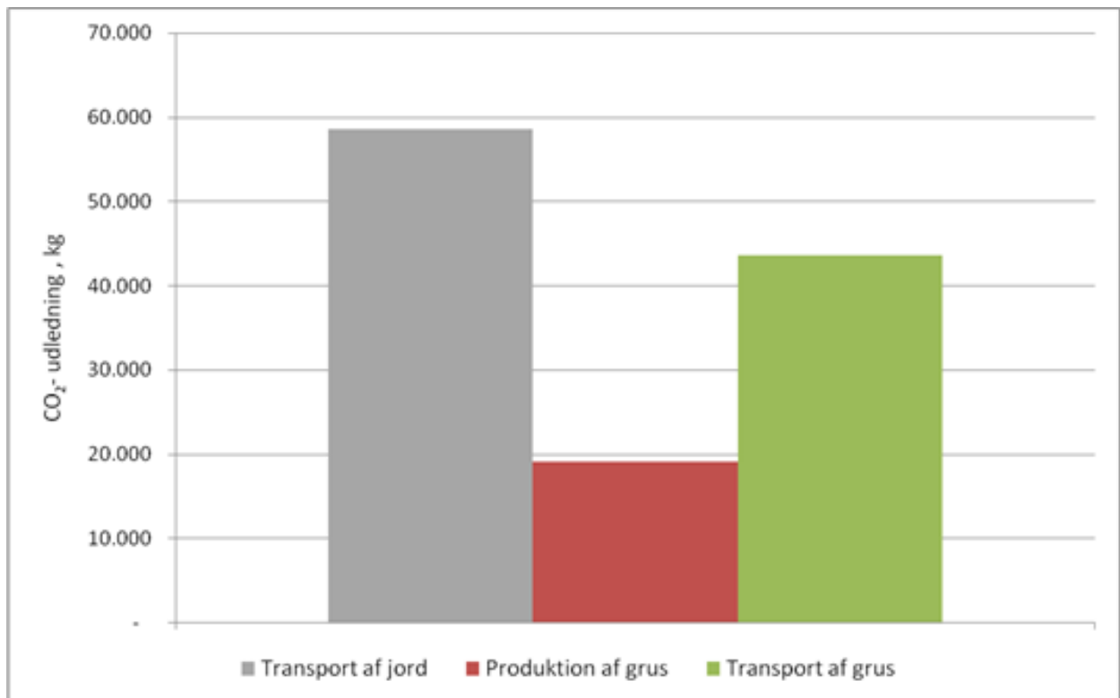
Figur 2: CO 2 -udledning ved etablering af 1 km vej på traditionel vis.
