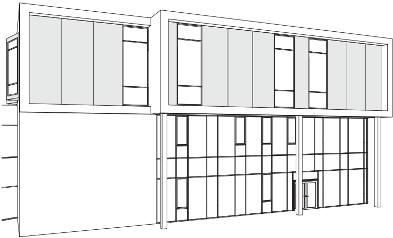
FACADE TYPE 3: FRONTFACADE, ÅBEN (SE OVERSIGT S. 32) Glasfacader med smalle kobberanodiserede aluminiumsprofiler mod Lille Tuborgvej i stueetage/parterre under gavle og murede facader
