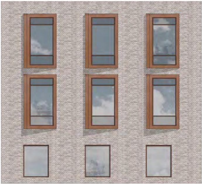
FACADE TYPE 1: ALMEN FACADE (SE OVERSIGT S. 32) Murede facader med vinduer eller karnapper beklædt med kobberanodiserede aluminiumsplader
