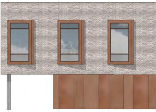
FACADE TYPE 2: FRONTFACADE, LUKKET (SE OVERSIGT S. 32) Facader beklædt med kobberanodiserede aluminiumsplader i stueetagen under gavle og murede facader mod Lille Tuborgvej
