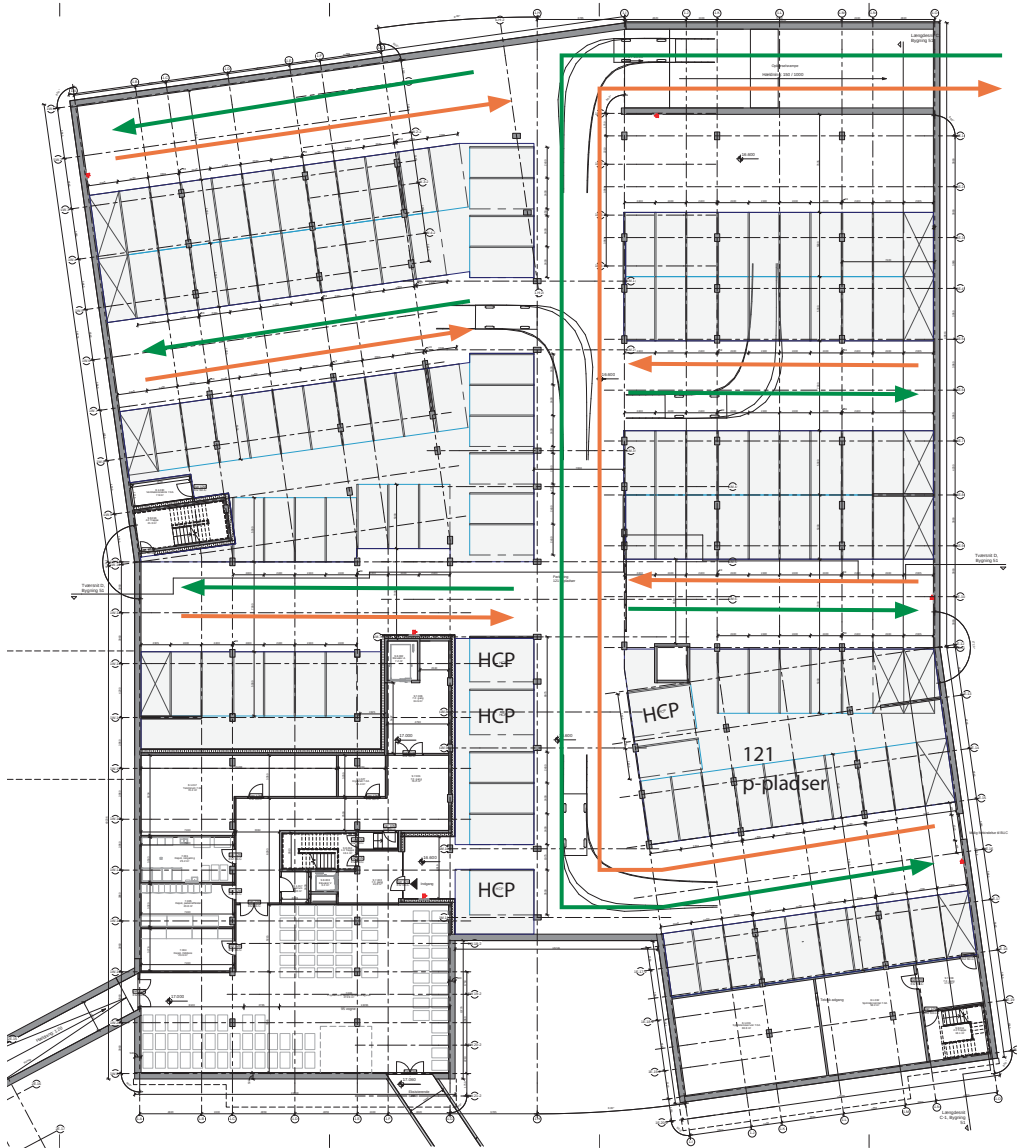
PARKERING I KÆLDER
