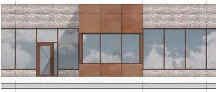
FACADE TYPE 4: GAVL (SE OVERSIGT S. 32) Facader beklædt med kobberanodiserede aluminiumsplader og indrammet af en muret kant
