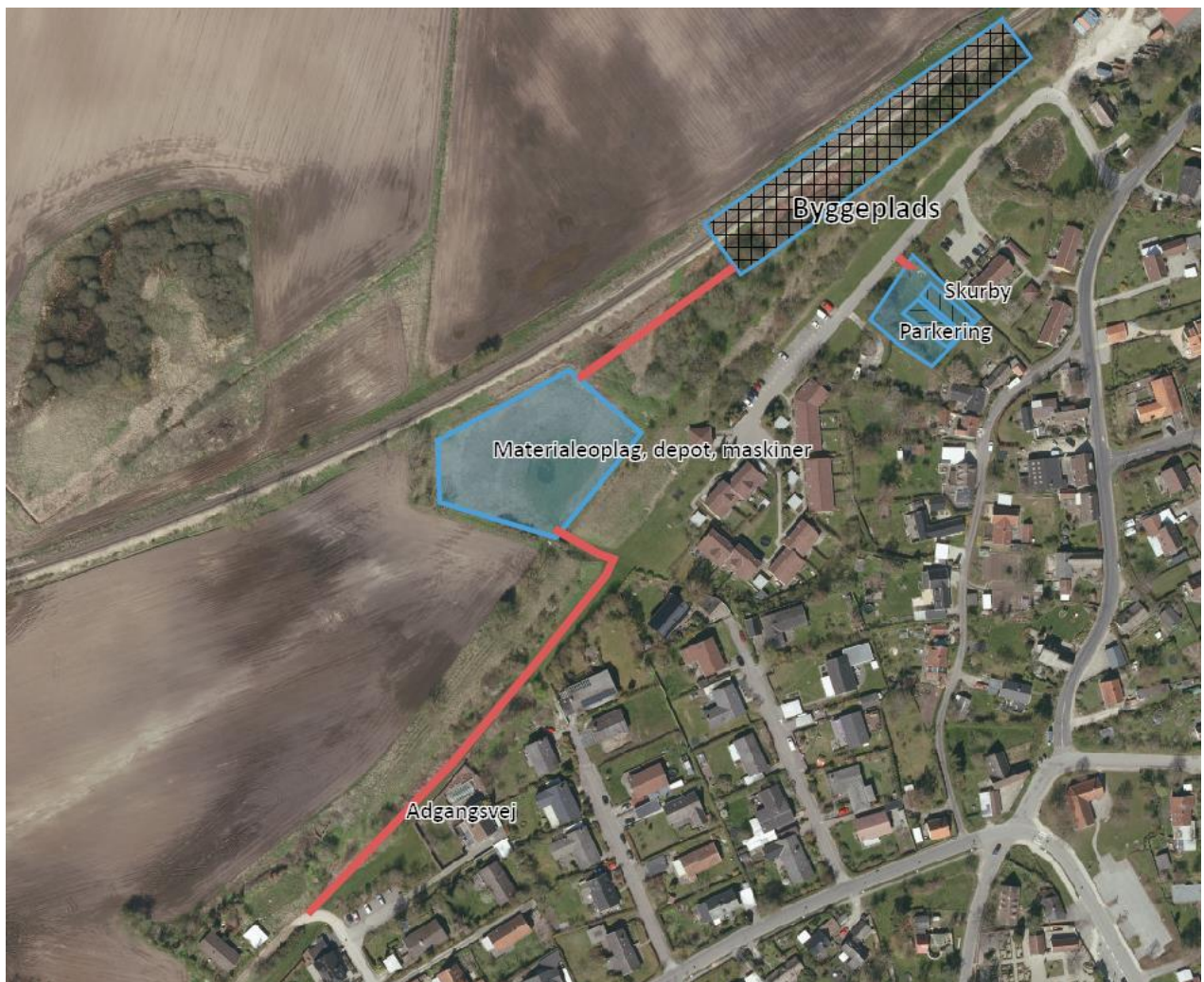
Figur 5-2 - Arbejdspladsareal til brug for bygning af den nye perron
